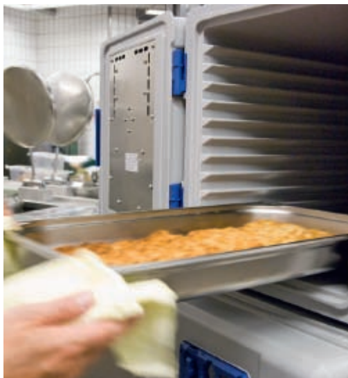
Der Blancotherm 420 KBRUH hat elf Paar Auflegesicken zum Einschieben von Gastronomiebehältern (Sickenabstand: 31 mm).
