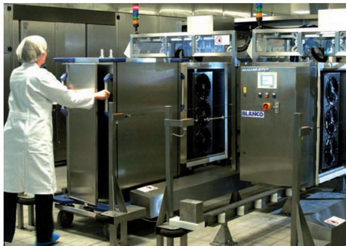
Befüllstation für Tablett-Transportwagen im Versorgungszentrum Stuttgart, wo das Blanco-Ice-System erstmals umgesetzt wurde: Umgehend sind die Wagen einsatzbereit und halten die Kälte bis zu zwölf Stunden
